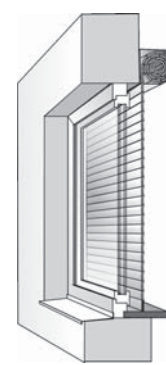
Vnitřní povrchová montáž
